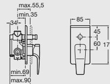
**Grifería termostática empotrable de 1/2" para baño o ducha (40 l/min)**
